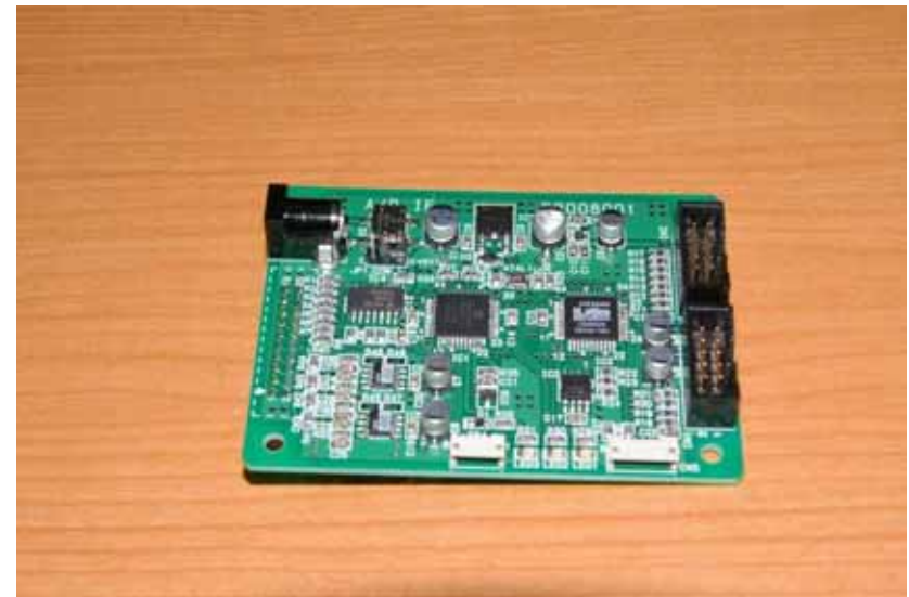
デジタルデータ蓄積ボード 3軸, 800SPS, データ長約2分
