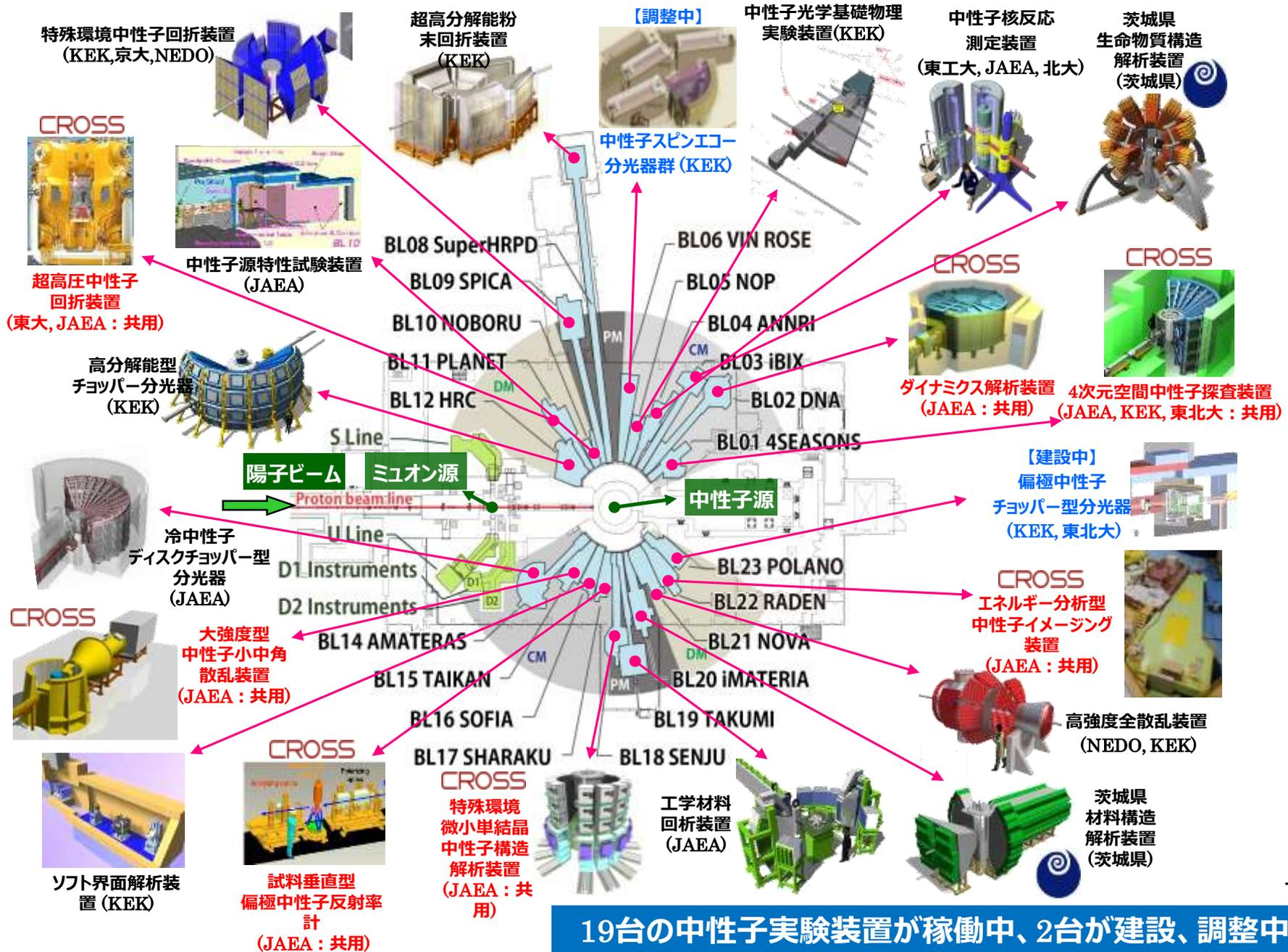
19台の中性子実験装置が稼働中、2台が建設、調整中
