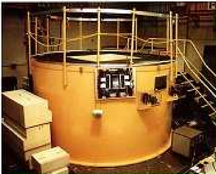
UTR-KINKI(生物遮遮蔽タンク)の外観
