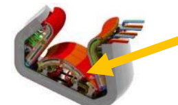
高熱負荷機器(ダイバータ)の設計
