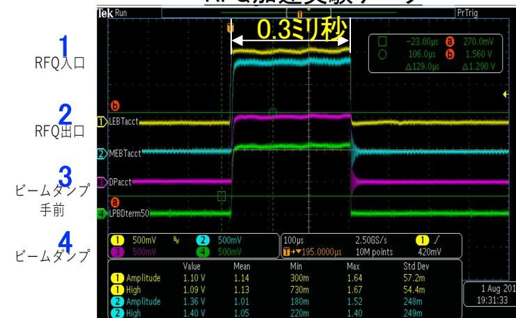
50keVのエネルギーの入射ビームがRFQで加速され2.5MeVになって出力(陽子ビーム電流25mA)。
