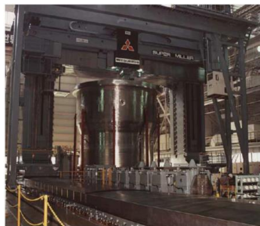
大型部材の高精度機械加工
