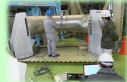
(「もんじゅ」配管表面清掃装置)
