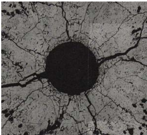
O/M=1.96, ギャップ幅160µm
