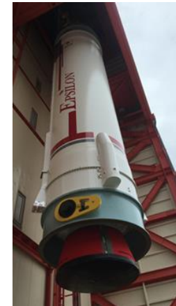
1段モータ吊上げ
