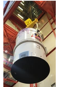
2段モータ吊上げ
