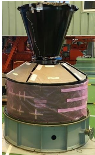
3段モータ (写真はノズルアップ)
