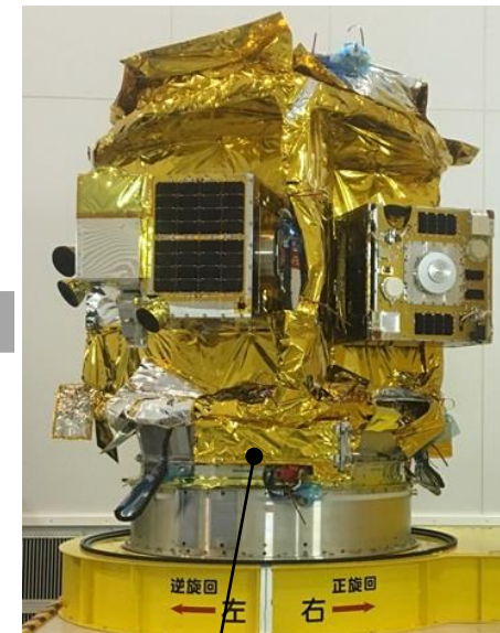
キューブサット放出装置を 複数衛星搭載構造に取付
