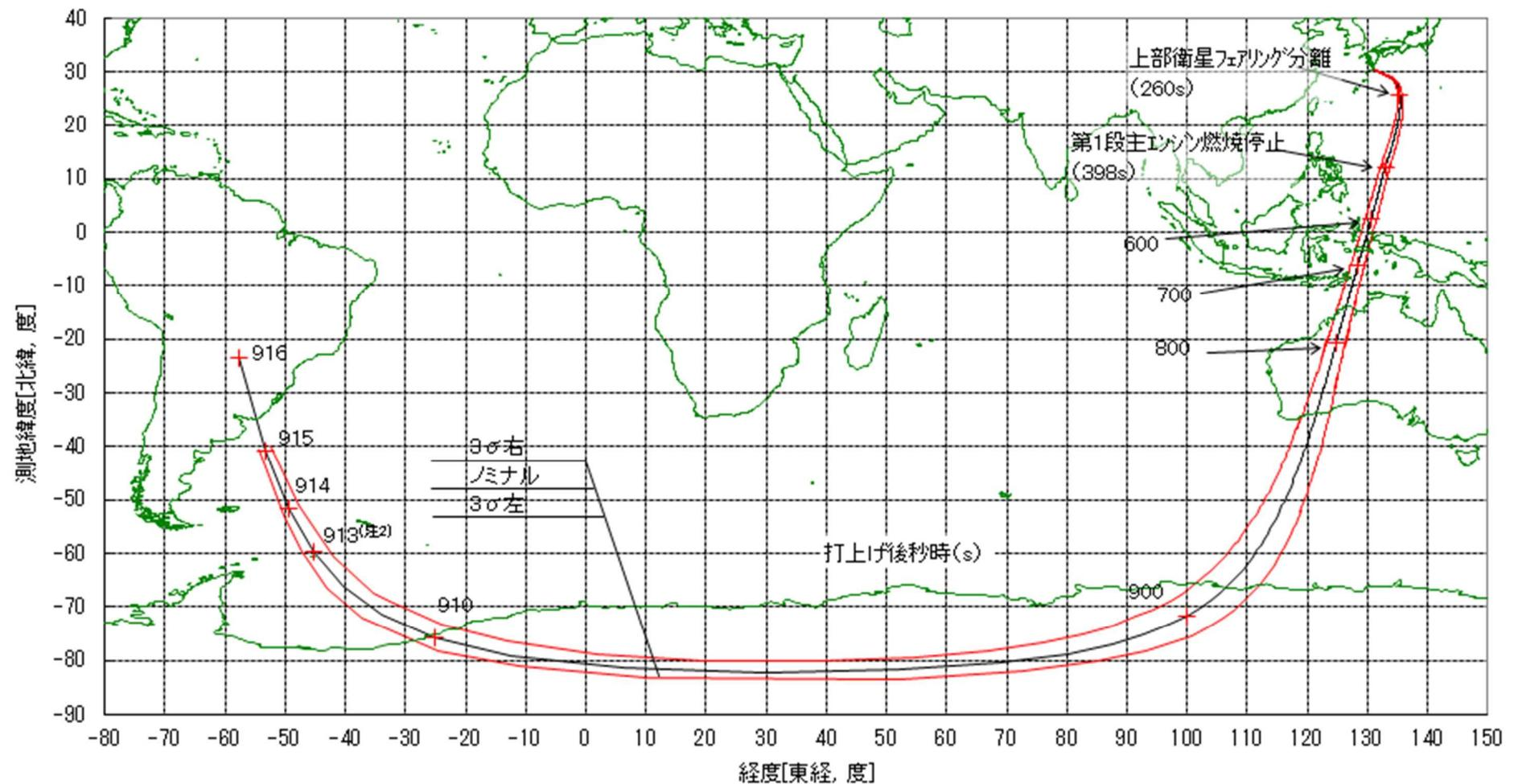
図7 ロケットの落下予測点<sup>(注1)</sup> 軌跡と3σ分散範囲
