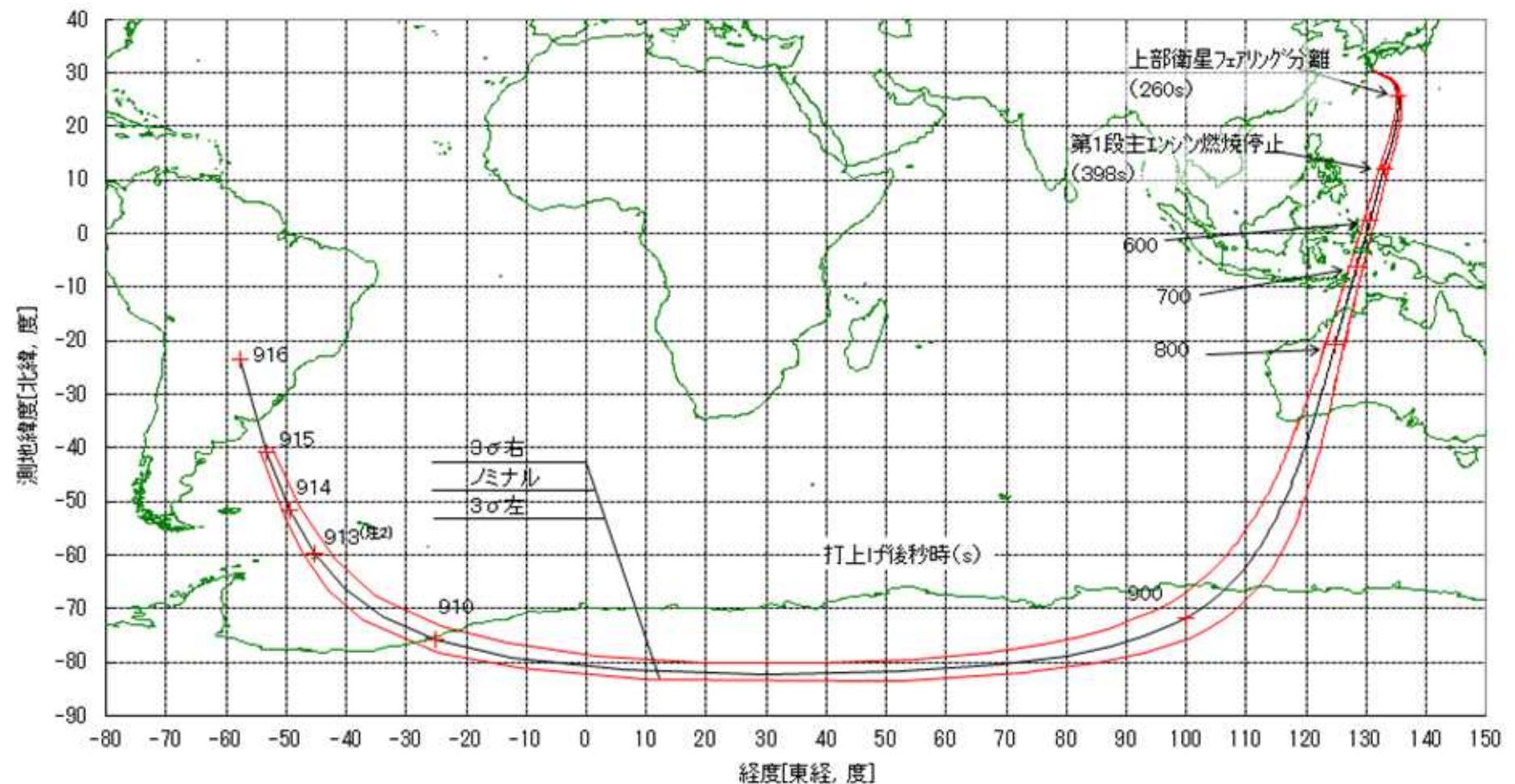
**図11:ロケットの落下予測点<sup>(注1)</sup>軌跡と3σ分散範囲**
