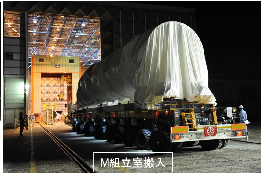
1段モータ輸送・搬入の状況
