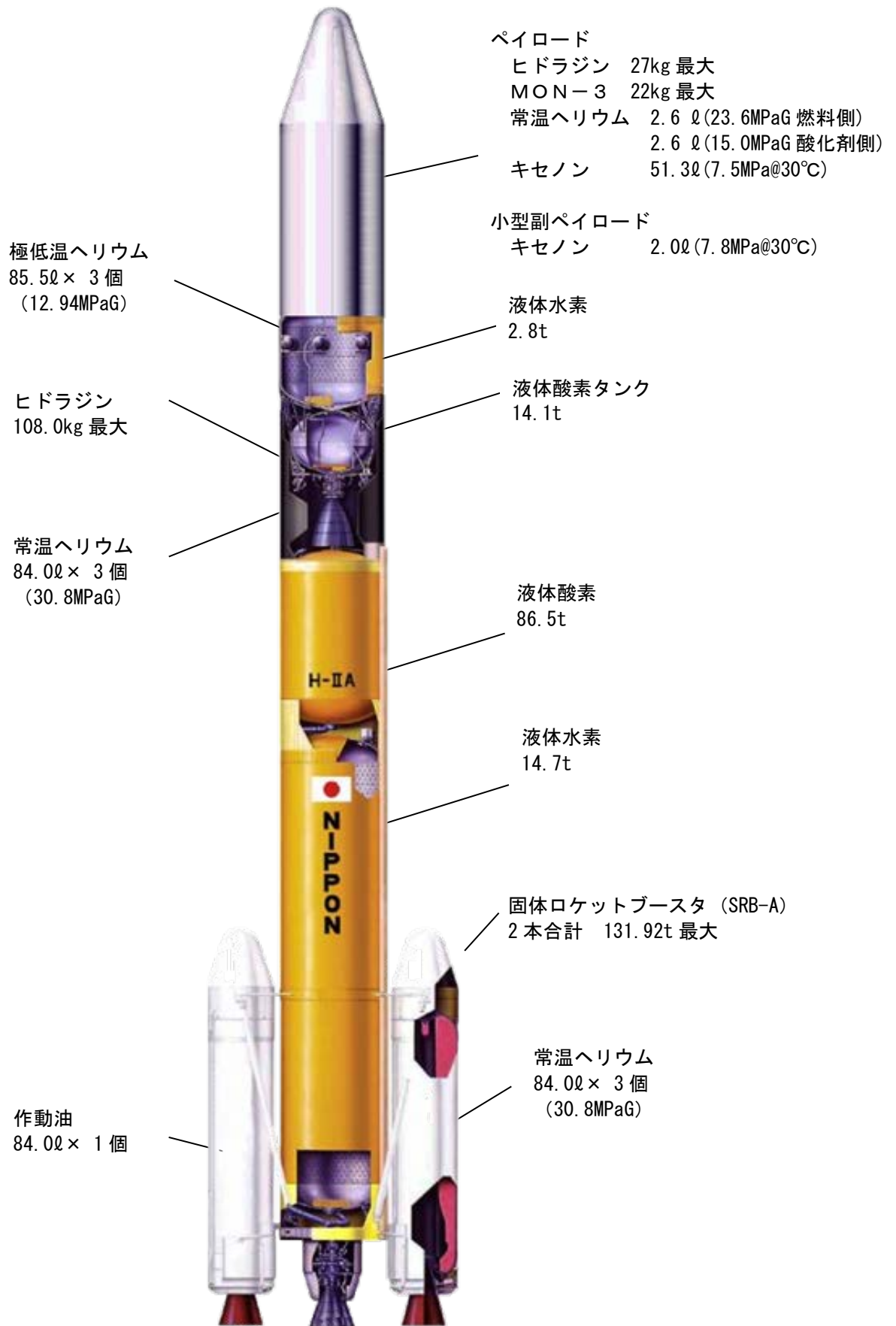
図-1 H-IIAロケット搭載用保安物概要 (火薬類、高圧ガス及び危険物)
