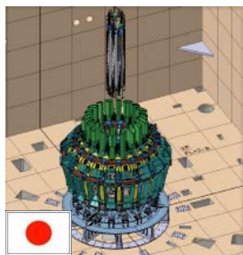
上部平衡磁場コイルと 中心ソレノイド(180トン)
