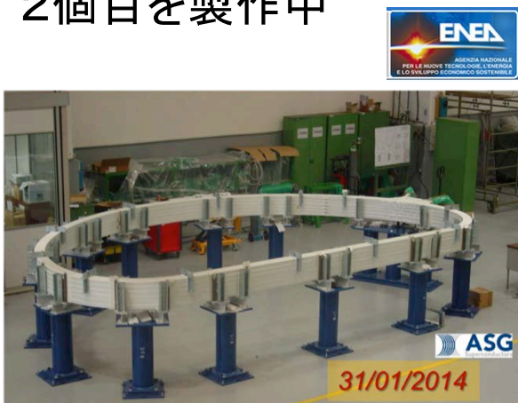
巻線 (ENEA) 2個目を製作中
