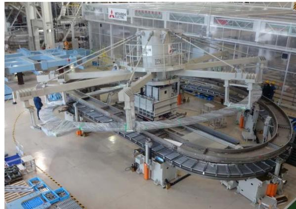
実規模RP(ラジアルプレート)のトランスファーを高精度で実証(三菱重工)
