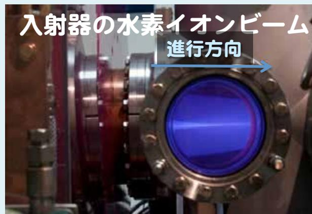
加速電圧：100kV (目標：100kV)
