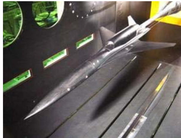
風洞試験の様子
