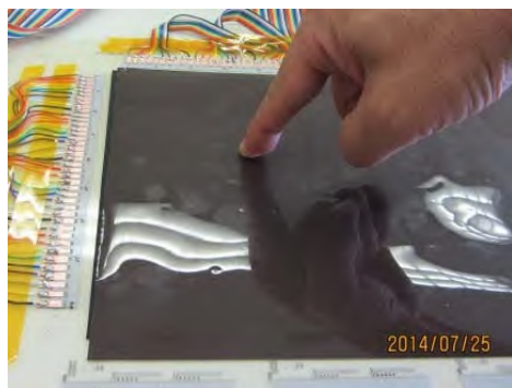
印刷エレクトロニクス技術により 作製した感圧シートセンサ (技術組合JAPERと協働)
