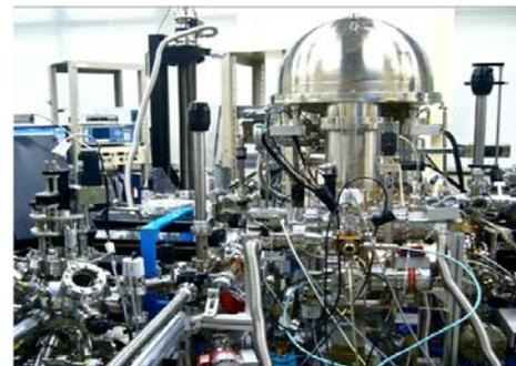
スピン及び角度分解型光電子分光装置
