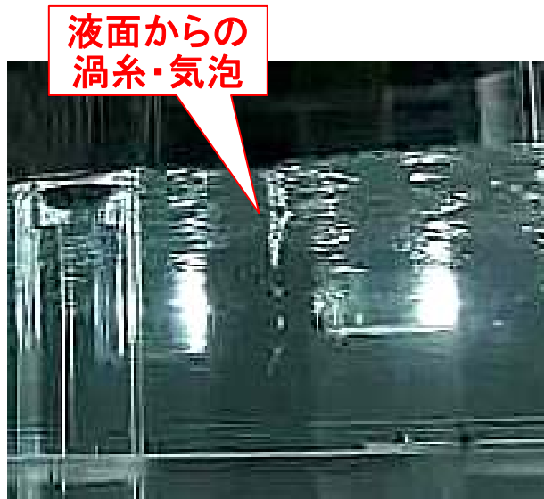
旋回渦によるガス巻き込み発生 (液面近傍の流速に依存)
