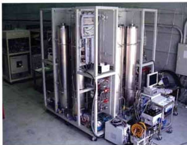
助成事業で製作した連続クロマト大型実証試験装置 (サイズ: 2M × 2M × 2.5M 処理能力: 10L/min)
