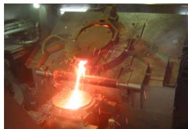
注湯機から遠心铸造機への出湯
