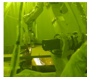
レーザー切断装置を用いた切断作業
