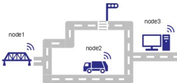
図15(a) DTN を用いた構造物健全性モニタリングシステム。
