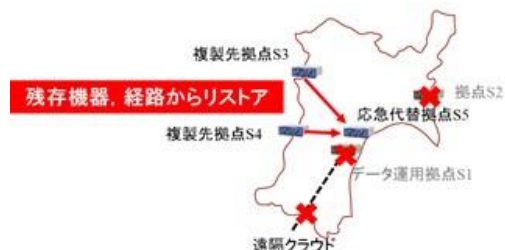
図 1-2 マルチルートリストア方式の概念的説明
