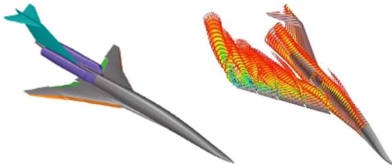
離着陸騒音低減のための高揚力装置最適設計例
