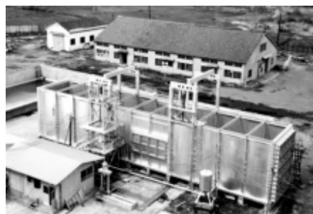
図2 胴体内圧繰り返し荷重試験
