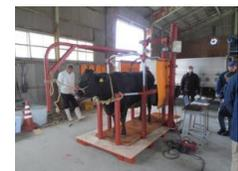
和牛体内のセシウム濃度を生きたまま正確に測定する技術が完成、26.3月～運用開始(コムテックエンジニアリング等×福島県農業総合センター等)
