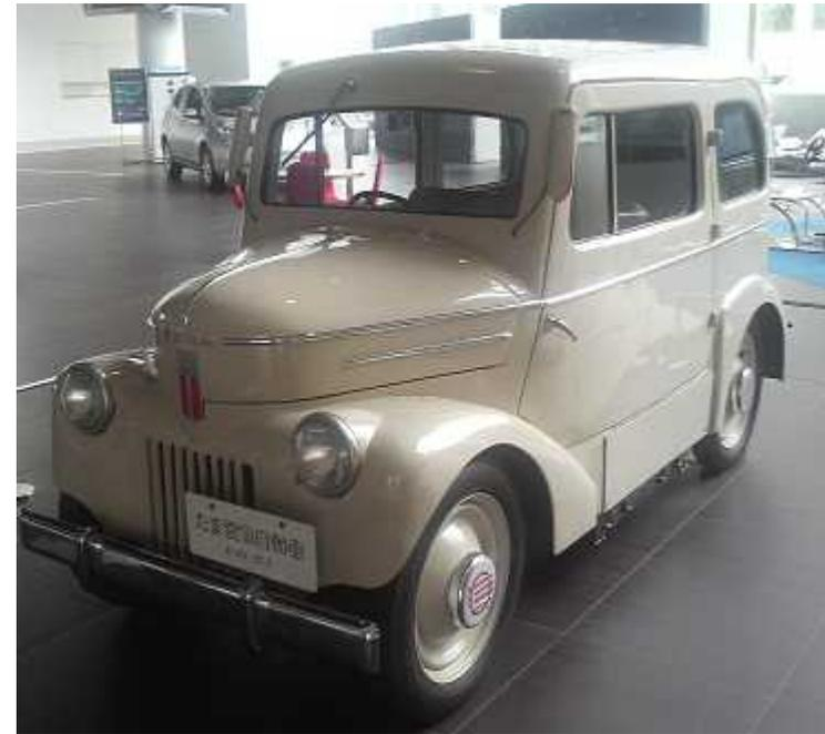
立川飛行機(後のプリンス自動車)は1947年に「たま」と名付けた電気自動車(E4S-47)を開発している。この当時の性能は2ドアセダン最高時速35km/hであったが、1充電で200kmの走行が可能であったとされる。
