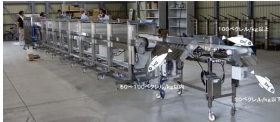
**連続個別非破壊放射能測定システム**
