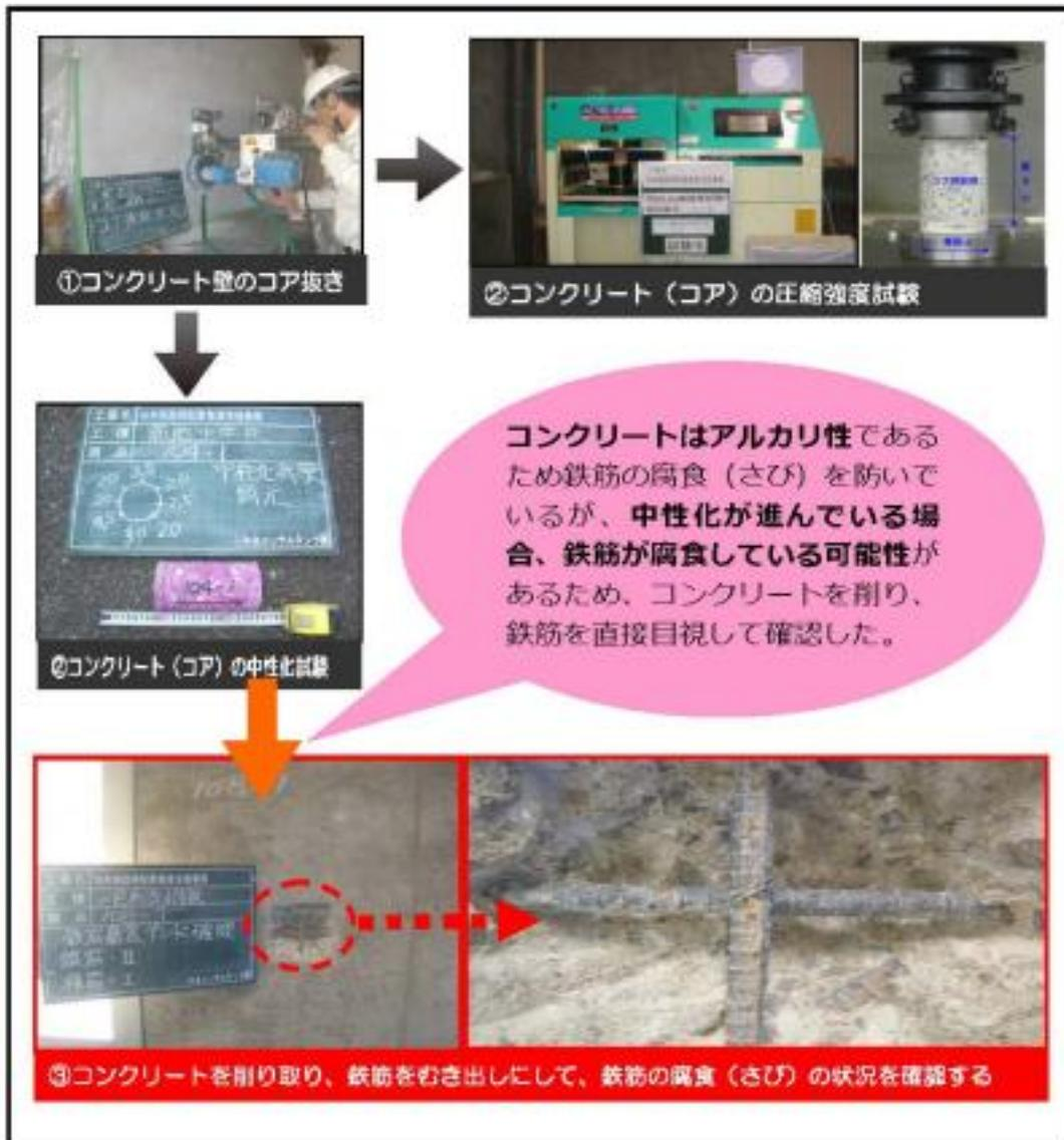
【図表：構造体劣化調査に基づく物理的（構造的）耐用年数の分類】
