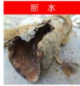
■排水管 経年36年劣化により腐食、破損し、排水が漏洩。
