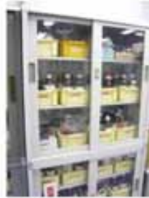
地震時に薬品ビンが破損しないよう、仕切りがあるケースに設置
