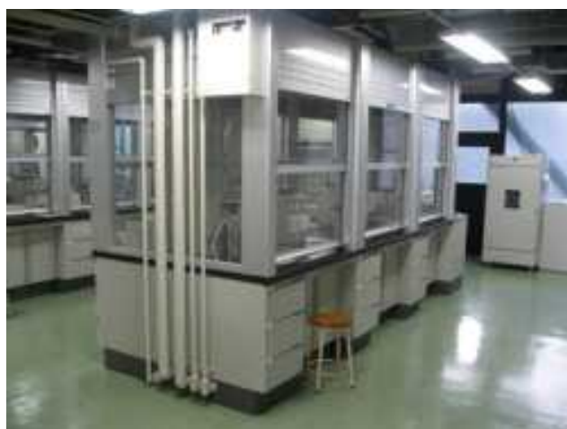
実験台全体をフードで覆い化学物質等のばく露を防止
