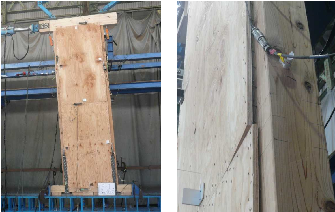
写真 2.2.2.2 破壊状況 (左：耐力壁の変形の様子と右：面材釘の引き抜け)
