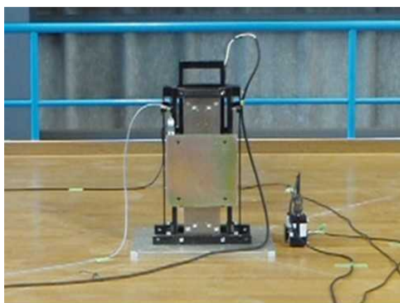
写真 1.2.3.1 起震機を使った床の振動実験
