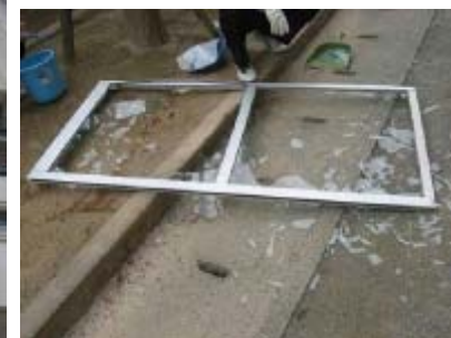
落下して破損した障子
