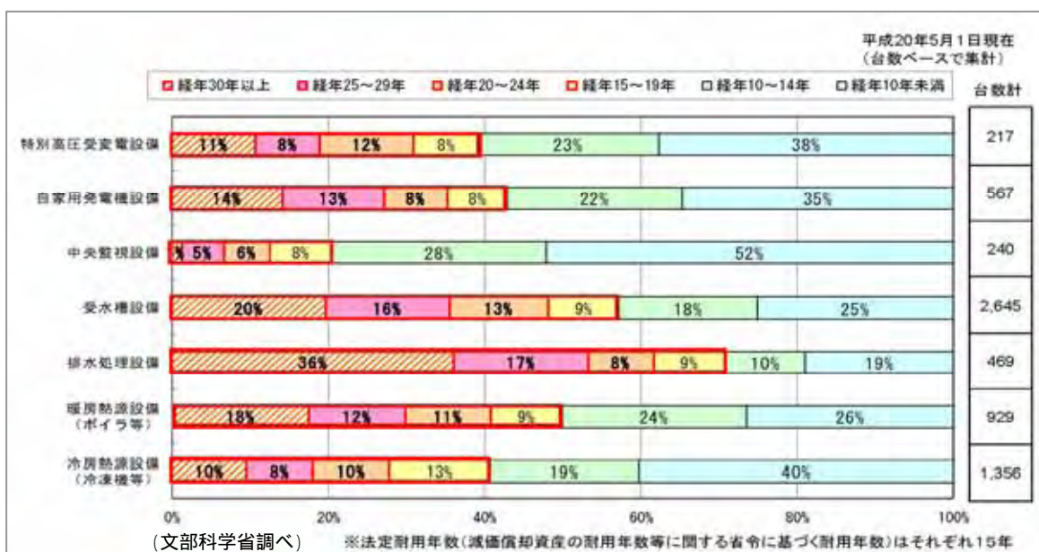
図表9 国立大学法人等における主な基幹設備の老朽化状況
