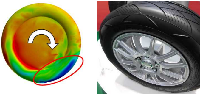
自動車用タイヤ空力形状設計: 空気抵抗と揚力を同時に低減できる画期的な形状を発見。右図は東京モーターショー2015で展示された試作品
