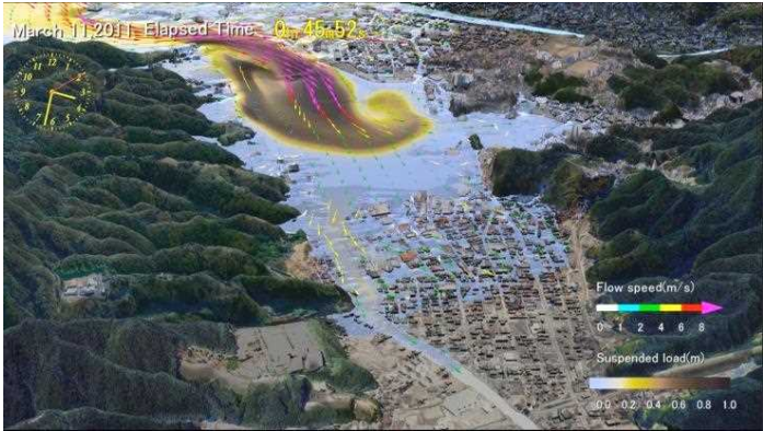
2011年東北地方太平洋沖地震による津波の気仙沼市の再現計算(複合的な被害である津波土砂移動と船舶漂流の連成解析)
