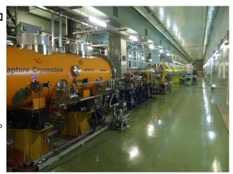
調整し、最終的に並べたものすべてが設計値から 0.3mm 以内にはいるように調整をしている。これらは地震で動かないように床に固定される。加速空洞本体は特に精密な調整をしていない。通常、加速器はミクロン単位の精度で製作するが、ILC の加速空洞はコストダウンのため 1 枚板をプレスし張り合わせて電子ビーム溶接をし、最終的に軸進捗度と共振周波数のみを専用の調整装置で調整している。
