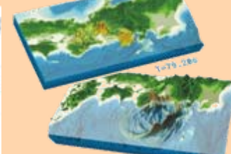
地震波伝播計算と津波発生伝播の連成シミュレーション
