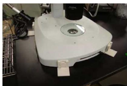
固定具による顕微鏡類の固定
