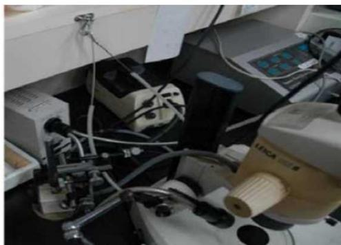
荷締めベルトによる顕微鏡補器類の拘束、ワイヤによる実体顕微鏡の落下防止
