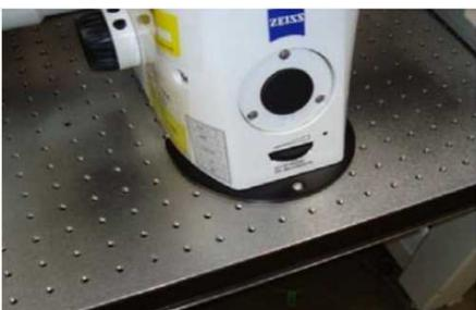
専用金具による除震台への顕微鏡の固定
