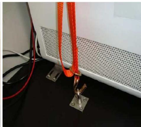
荷締めベルト、底部ブランケットによる次世代シーケンサーの固定
