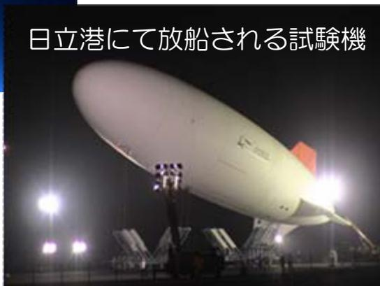
強化繊維でできた飛行船を成層圏高度(約16.4km)まで到達。 —世界初—
