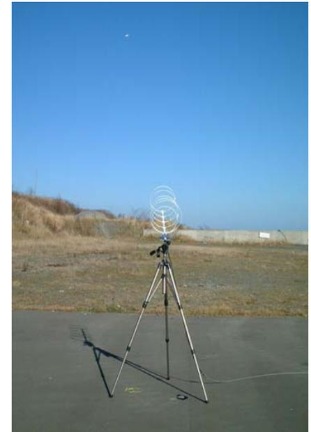
試験機方向に向けて設置された放送受信用リングアンテナ
