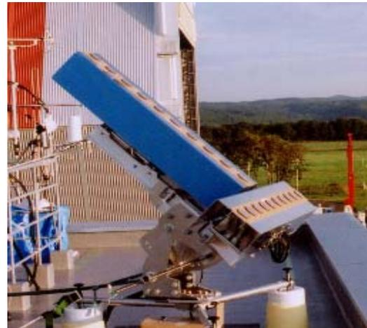
飛行管制棟屋上に設置した直交配列アレーセンサー
