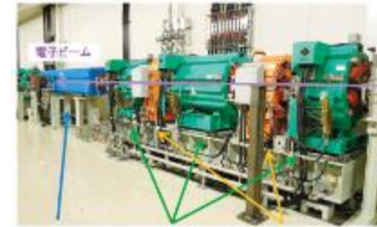
偏向電磁石(88台) 電子ビームの軌道を曲げる(1台で約4度) 4極電磁石(476台) 電子ビームの軌道を防ぎしぼる 6極電磁石(300台) 4極電磁石の働きを助けて電子ビームの安定性を高める
