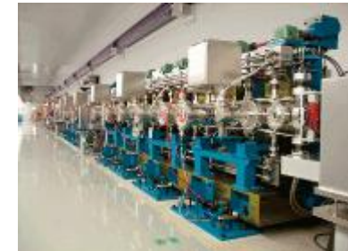
XFEL実現にも大きく貢献した真空封止アンジュレータ
