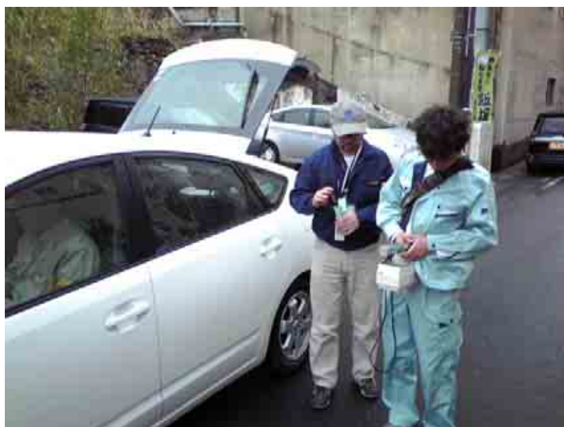
写真2 車体によるシールド効果の確認
