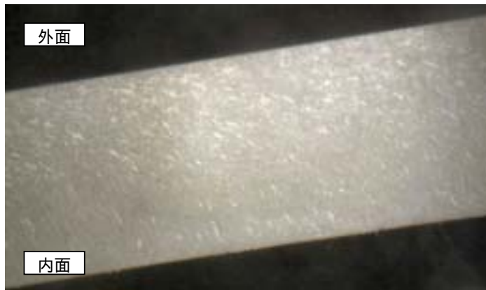
脆性破壊を示す「滑らかな断面」
