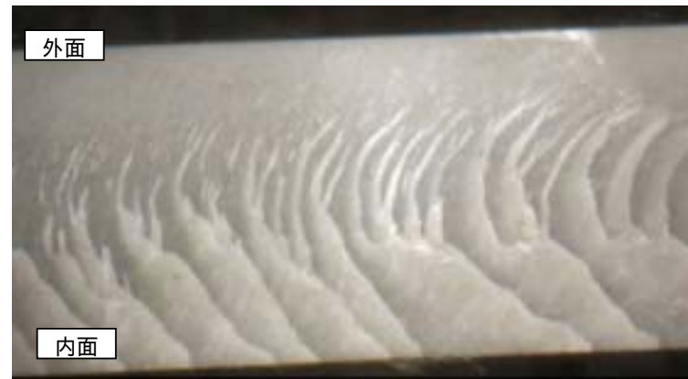
延性破壊を示す「荒れた断面」
