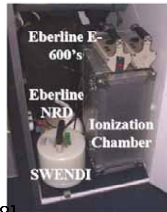
図6 カナダグループが使用した測定器[28]
