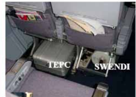
図6 カナダグループが使用した測定器[28]
