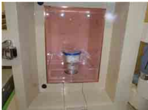
【線試料の測定】 (Ge半導体検出器)
