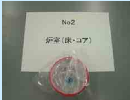
炉室床から採取したコンクリート
