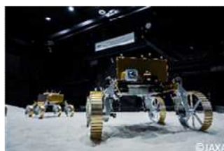
建設模型/試験モデル→試験プラットフォーム車両→建設機械と段階的に試験を実施
