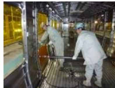
鉄道車両構体の歪取り作業(右側が受賞者)
