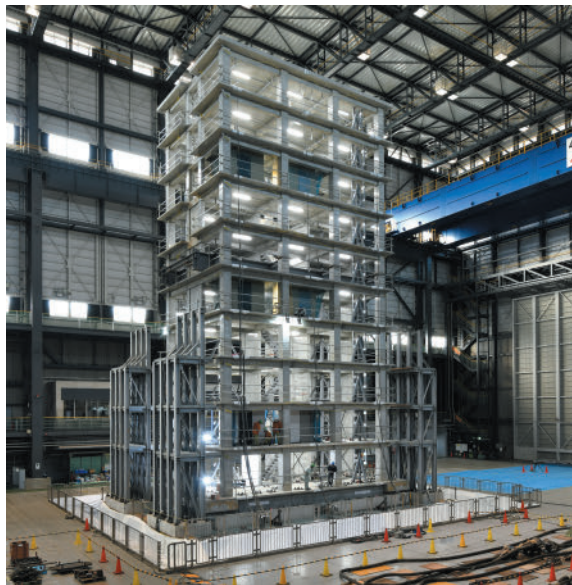
耐震性能の検証のため、平成30年12月と平成31年1月に実施した10階建て鉄筋コンクリート造建物試験体のEーディフェンス振動台実験の様子（写真提供：防災科学技術研究所（NIED））
