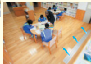
太陽熱により暖められた空気を校舎の床下に送風し、暖房に活用 (栃木県日光市立湯西川小・中学校)
